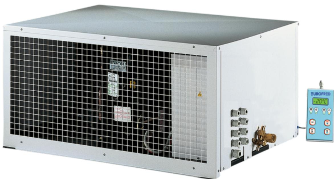
Equipos split BT bloc de techo con precarga de líquido refrigerante y desescarche por resistencias.
